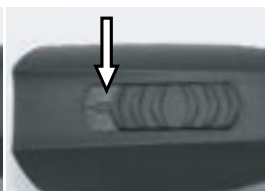
Fig. 6 Interrupteur position marche (« II »)
