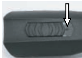
Fig. 4 Interruttore in posizione ferma ("0")
